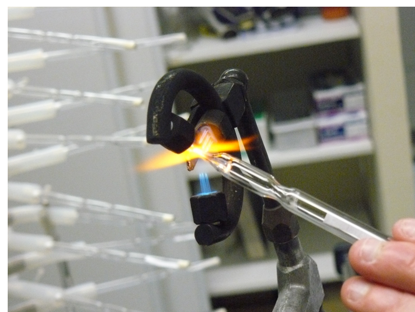
Scellage des ampoules
