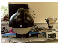
Imagerie hyperspectrale et multispectrale (Videometer). Exemple d'application : détection de la fusariose sur semences de blé par chimiométrie.
