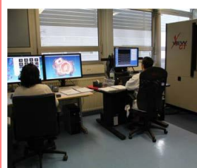
Imagerie RX. Tomographe tridimensionnel numérique micrométrique (NSI X50-CT). Reconstitution 3D de la structure interne de semences. Mesure et classification semi-automatique issues d'acquisitions 2D (imageur Faxitron MX 20DC12).
