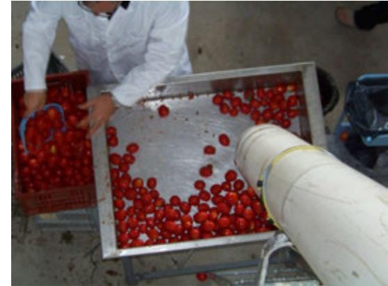
Une chute de 3m à travers un tube vertical jusque sur un plateau inox
